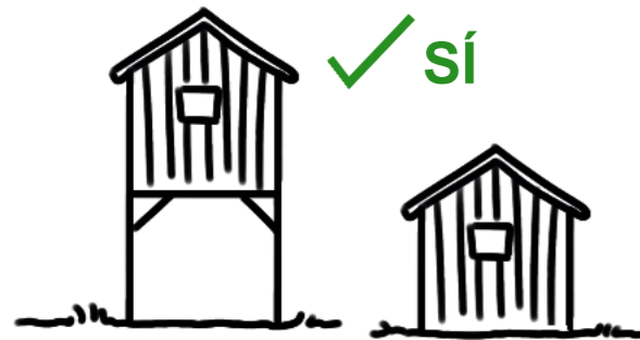
Cobertura y piso livianos (tipo madera o bambú).
