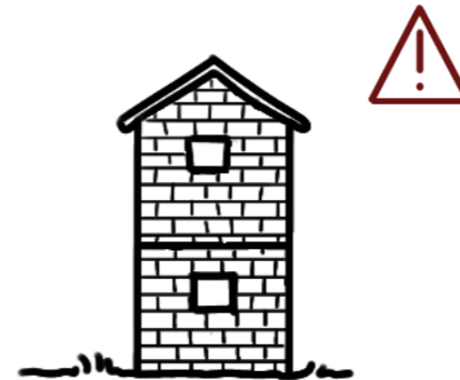
Cobertura liviana y 2 pisos pesados (tipo albañilería).
