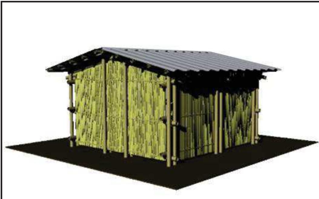
Esta gráfica muestra la fachada posterior y la fachada lateral izquierda de la vivienda (CRE) totalmente terminada. Se puede observar la parte visible de la estructura principal y el recubrimiento de las paredes con caña picada.
