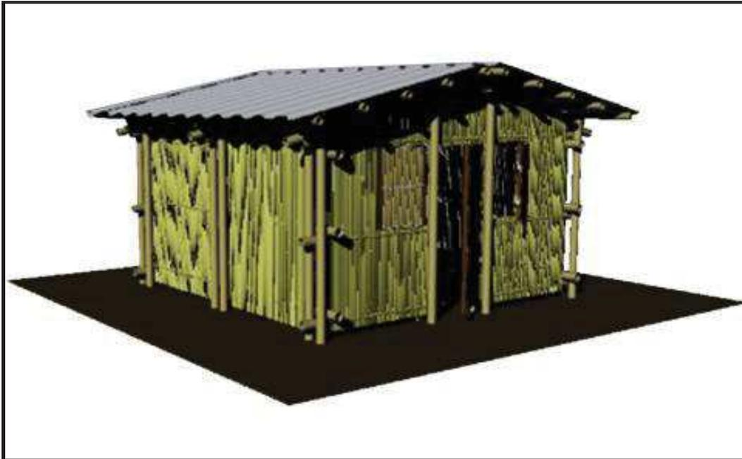
Esta gráfica muestra la fachada principal y la fachada lateral izquierda de la vivienda (CRE) totalmente terminada. Se puede observar la parte visible de la estructura principal y el recubrimiento de las paredes con caña picada. También se puede observar la ubicación de las ventanas y la puerta principal.
