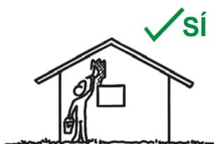
Tratar la madera y la guadúa anualmente contra los bichos (con borato u otros químicos). Posteriormente, colocar una capa de protección adicional contra el agua para que no se parta con la lluvia. Pintar elementos de metal expuestos para evitar corrosión (especialmente en entornos de alta salinidad).
