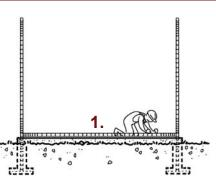
1. Después de la cimentación se construve la armadura de varillas de acero horizontal inferior y vertical, bien anclada en la cimentación.
