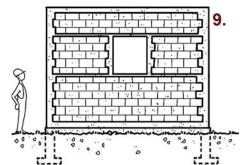
9. Solo al final se hace el hormigón de la viga solera superior, para acabar de confinar la pared (sin el mortero de relleno).
