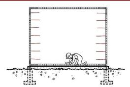
1. Se construve la armadura de varillas de acero con chicotes para anclar el cerramniento de bloques o de ladrillos.
