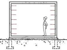
2. Se hace el encofrado y el hormigón. Se obtiene un pórtico de hormigón armado listo para el cerramiento.
