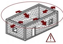
El anclaie entre la viga solera superior v el cerramiento está débil y tiene un riesgo de caída.
