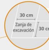
**Zanjas de excavación en forma de cuadrados de 30 cm, con profundidad de 40 cm.**
