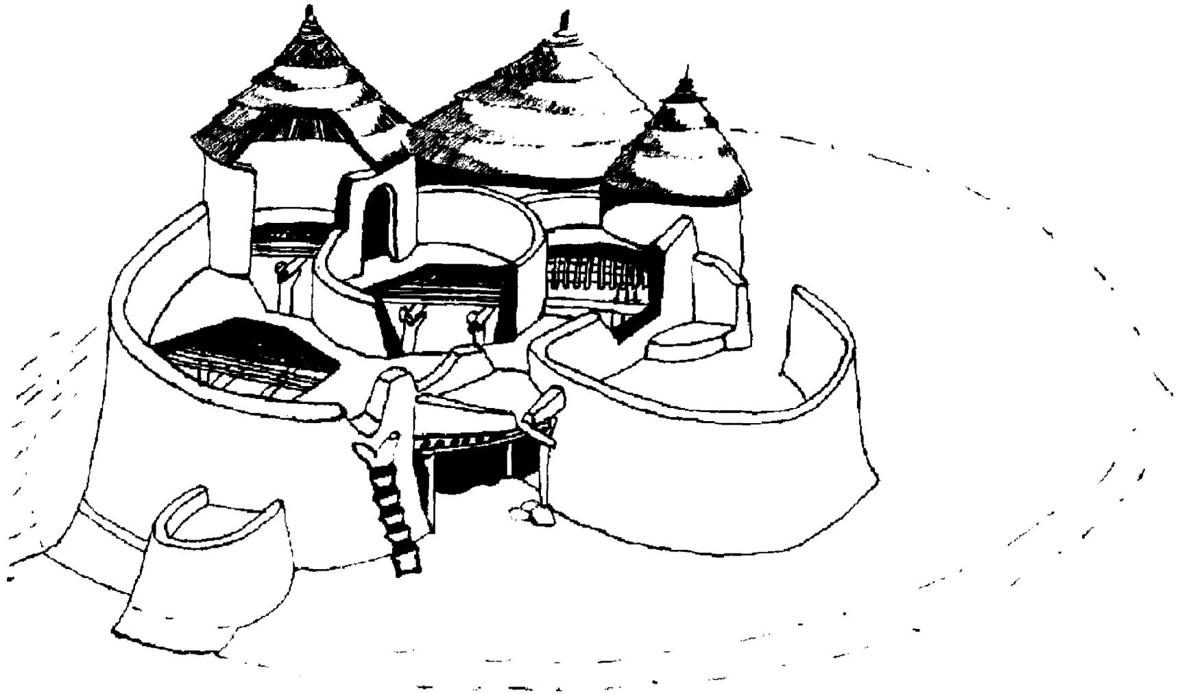
*Dessin 25. Coupe axométrique d'une concession Kasséna (Gourounsi) dressée sur une plate-forme.
