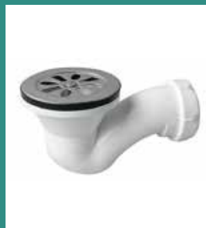
3 Tubo de 2" para evacuación de ducha con codo para evitar malos olores
