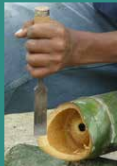
3 Corte boca de pescado con formón y martillo
