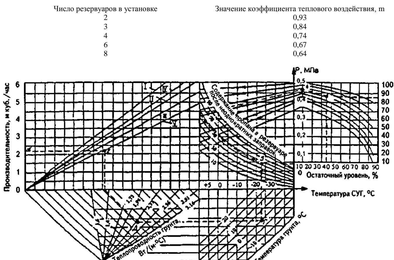
**Номограмма для определения производительности резервуара сжиженного газа вместимостью 2,5 и 5 м<sup>3</sup> (подземного)**
